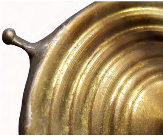
La membrane ondulée d'un des premiers baromètres anéroïdes de Lucien Vidie, les traces de l'outil de repoussage sont visibles, ainsi que la soudure à l'étain. (\*\*)
