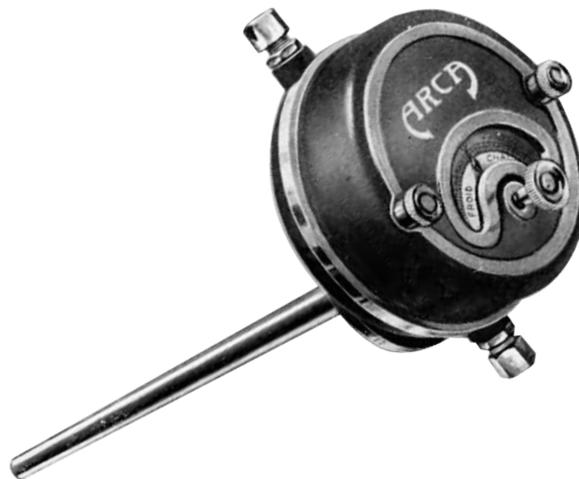
Régulateur de température à canne bimétallique, sur circuit air ou hydraulique, dit Thermo-relais (Catalogue Arca\*)
