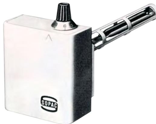
Airstat pour systèmes de chauffage à air pulsé, mécanisme à dilatation de liquide à deux bulbes pour régulation et sécurité. Contacts à rupture brusque à microrupteur, type ST (1977 Catalogue Sopac\*)
