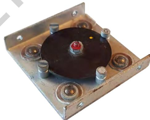
*Vue du dessus et du dessous, limiteur de température à rupture brusque avec disque de 29mm utilisé sur un équipement radio militaire pour mettre en marche la ventilation. Type « Blower thermostat » (Vers 1935-37\*\*)*
