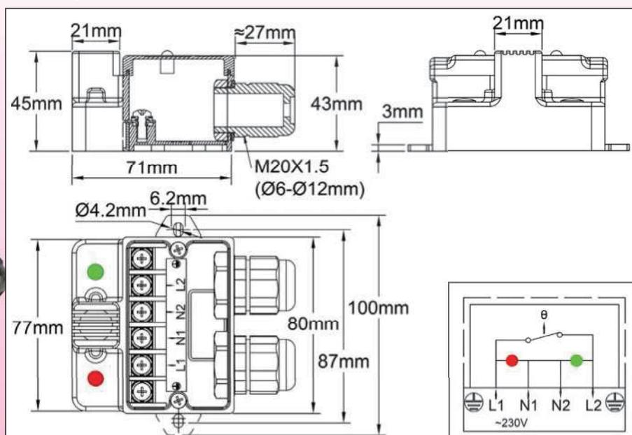
Dans ces boîtiers, le thermostat à température fixe de type bimétaballique, surmoulé, est thermiquement isolé de la paroi sur laquelle il est monté, et sa surface de mesure est mécaniquement protégée par une grille. Il est situé en avant du coffret afin de se trouver dans une zone de circulation naturelle de l'air ambiant.
